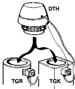
DTH er konstruert for bruk sammen med takgjennomføring TGR eller TGK, noe som sikrer enkel og korrekt montering.
