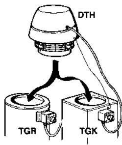
DTH er konstruert for bruk sammen med takgjennomføringen TGR eller TGK, noe som sikrer enkel og korrekt montering.
