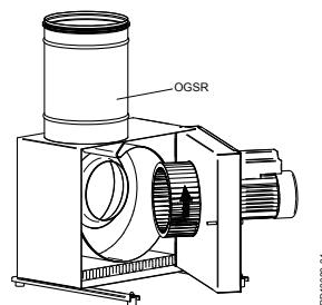
For å minimere systemtrykkfallet ved tilkobling til kanalsystemet, kan vi anbefale at det monteres et OGSR-overgangsstykke (tilbehør).
