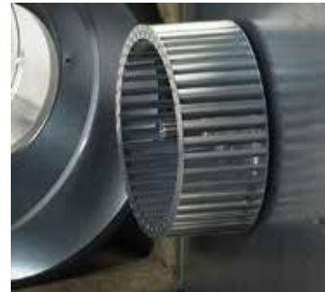
BESF-boksvifte har motoren koblet direkte til viftehjulet.
