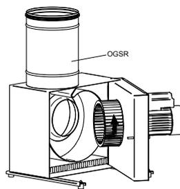
For å minimere systemtrykket ved tilkobling til kanalsystemet, kan vi anbefale at det monteres et OGSR-overgangsstykke (tilbehør).
